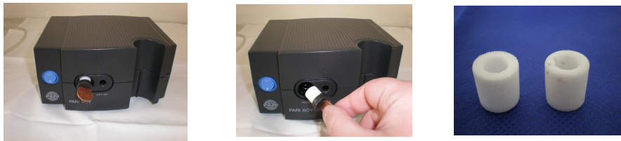
Σχήμα 6.4: Αλλαγή φίλτρου σε κομπρέσορα PariBoy
